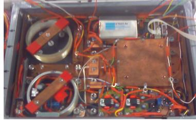
Bildbeispiel zweier Faserstretcher in einem Michelson-Interferometer zum Zweck der Implementierung der Time-Bin-Kodierung. Links oben ein Faserstretcher auf piezoelektrischer Basis mit dem regelbaren 1kV-Netzteil rechts daneben und links unten ein Stretcher mit thermischen Wirkprinzip auf Aluminiumring aufgebracht, beide mit einem Durchmesser von 70mm.
